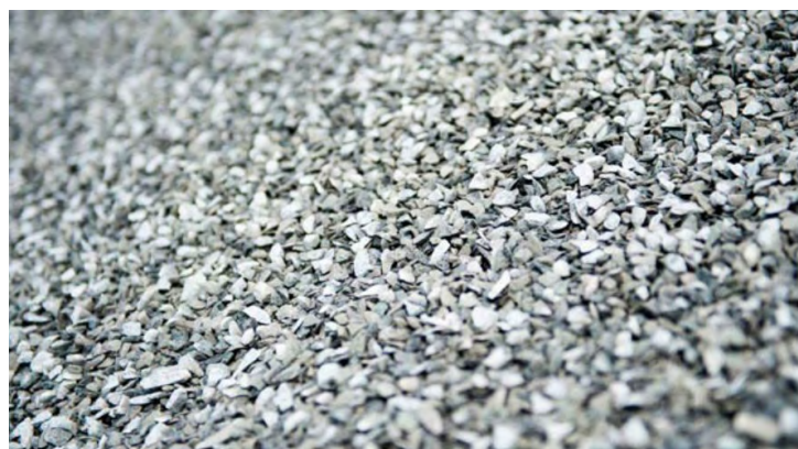
Maskinsand er kantete og inneholder mer finstoff enn natursand. Infiltrasjonsevnen blir derfor dårlig ved bruk i regnbed. Foto fra Herremyr Gård.
