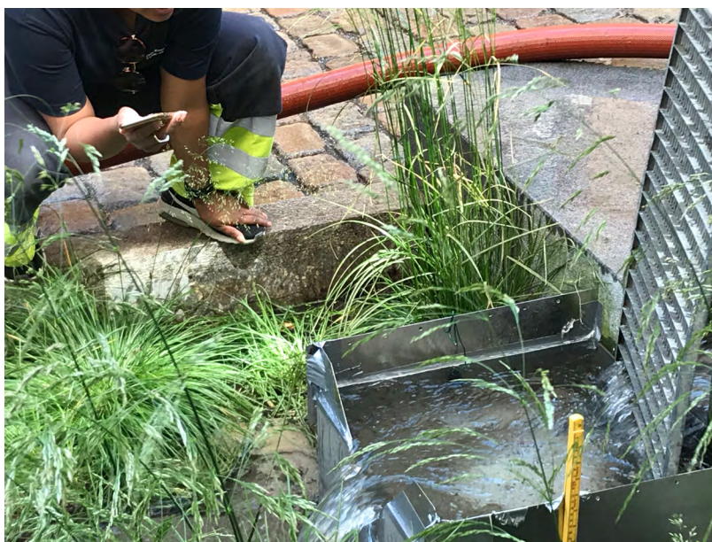
Testing av regnbedene i Deichmans gate viste at terskelementet ved innløpet ikke var dypt nok til å lede tiltenkte overvannsmengder til bedet. Testingen avdekket også at jordoverflaten i et av regnbedene var anlagt skjevt slik at vannet gikk i overløp over kanten lenge før det prosjekterte fordrøyningsvolumet var fylt opp. Foto: Nevedda Sivakumar og Gerd Minde.
